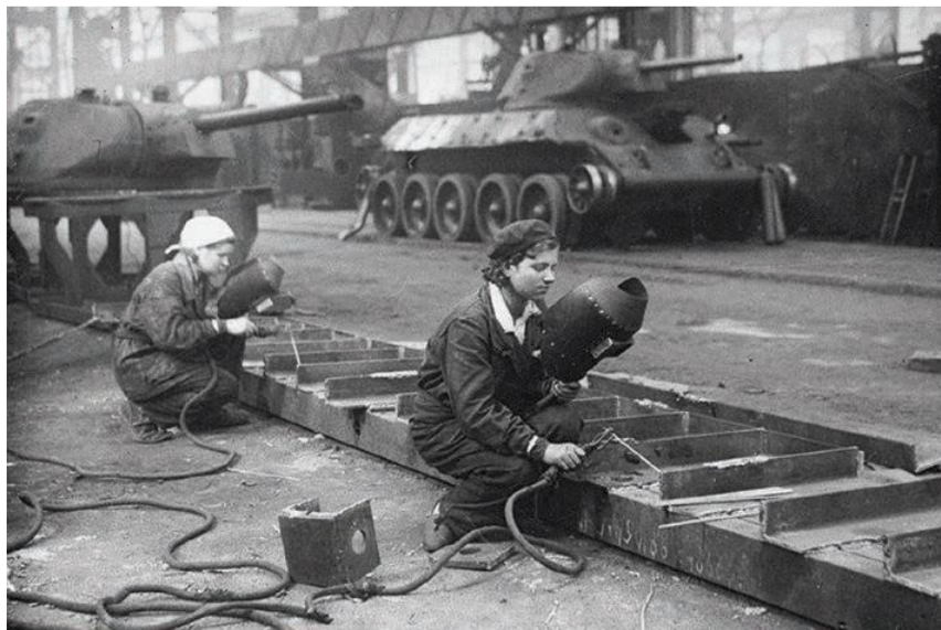
شکل ۲۷ - جوشکاران زن در حال کار در کارخانه مخازن اورال در کارگاه مونتاژ تانک های T-34 در Nižnij Tagil، روسیه، ۱۹۴۴. منبع: waralbum.ru.
