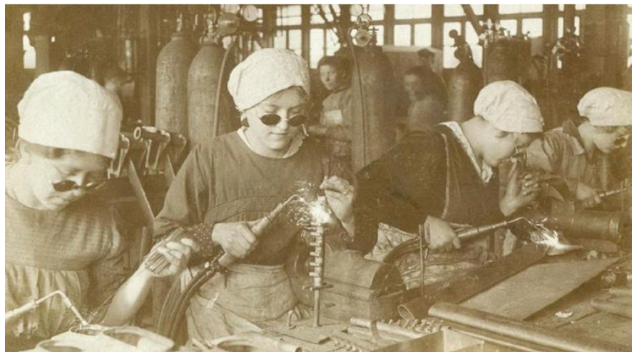
شکل ۱۳ - جوشکاری اکسی استیلن در آلمان در دهه ۱۹۳۰.
